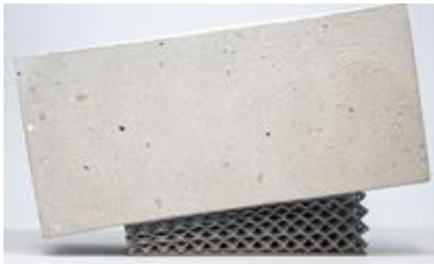
Abb. 2 SpheroFlex® TPU 50- Gitterstruktur mit fließendem weich-hart-Übergang unter Be- lastung
