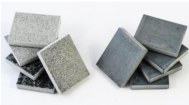
Abb. 4 Vergleich zwischen unglätteten Bauteilen (links) und geglätteten Bauteilen (rechts)
